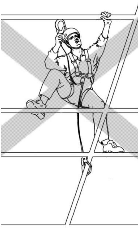
**Figura Q.3 - Fijar un elemento de amarre de anclaje (o eslinga de anclaje) de forma que pueda deslizarse hacia abajo durante una caída aumenta el potencial f toda la distancia**
