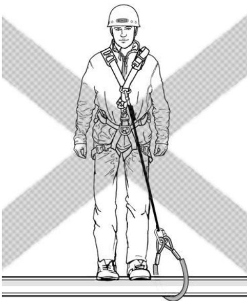
**Figura Q.2 - Elevar una eslinga de anclaje de su posición normal de suspensión aumenta el potencial distancia de caída**
